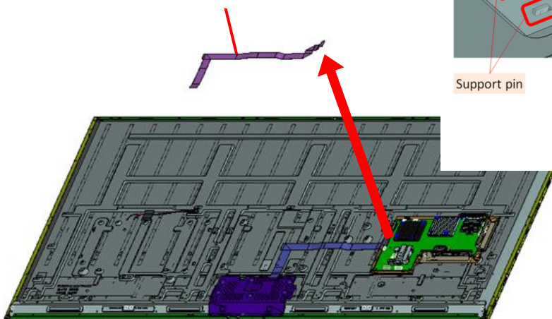
2 FLEXIBLE FLAT CABLE 41P P/N: 1-848-890-11
