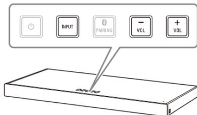
**Presione VOL -, VOL +, y VOL -, en ese orden, mientras mantiene presionado INPUT en la unidad.**
