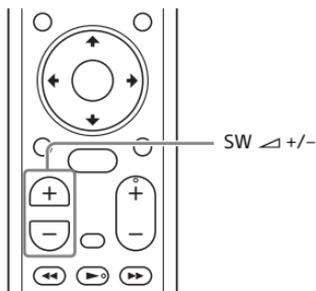
Appuyez sur SW (volume du caisson de graves) ▲ +/- pour régler le volume du caisson de graves.
